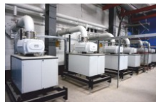
Вакуумная установка электронно-лучевой сварки
